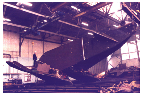
Een 65 tons Stevpris anker met van den Haak, houdkracht 1500 ton in zeer zachte grond.
